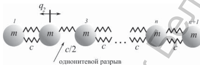
Рис. 1. Модель молекулы ДНК с однонитевыми разрывами: c – константа упругого взаимодействия; q_2 – отклонение второй частицы от равновесного положения; m – частица с массой 660 а. е. м. (пара нуклеотидов)
